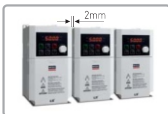
Montaż jeden obok drugiego (przerwa 2mm)
