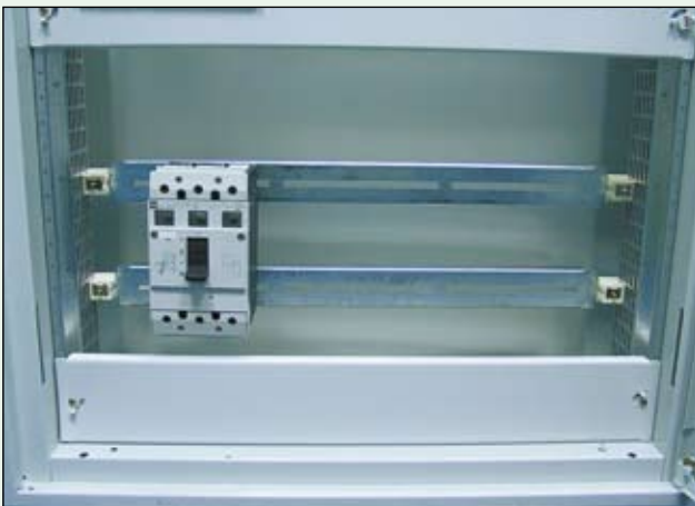
Montaż rozłącznika przy użyciu dwóch paneli MPN 3/050 i 2 par BEL (zamontowanych od tyłu)
