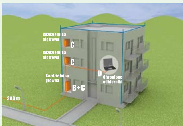
Budynek wielopiętrowy z instalacją odgromową, zasilany linią kablową. Montaż ograniczników przepięć: rozdzielnica główna – klasa B+C (I+II), typ SP-B+C/3.. rozdzielnice piętrowe – klasa C (II), typ SPC-S-20/280/.. Przy czułych urządzeniach (komputery, serwery itp) zalecany montaż ogranicznika przepięć klasy D (III), jak najbliższej chronionego urządzenia.
