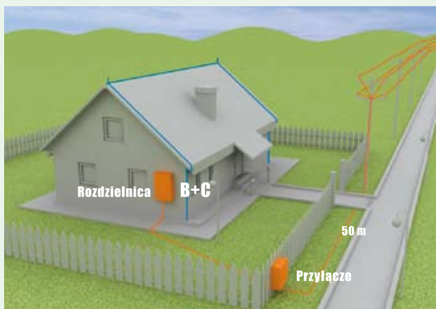
Budynek z instalacją odgromową zasilany linią kablową. Zalecany montaż ogranicznika przepięć klasy B+C (I+II) typu SPB-12/280/.. w rozdzielnicy głównej.
