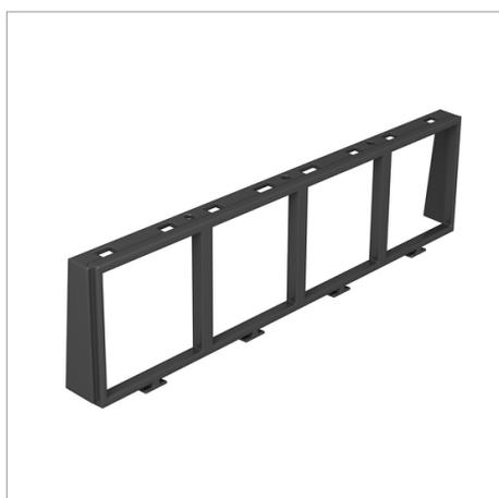
Zum Einbau von 4 Einzelgeräten Modul 45 für Geräteinsatz System 55 mit Montageträger für vertikalen Einbau von Modul 45-Geräten. Der Einbaurahmen ist vorgesehen für die Anwendung mit 0°-Steckdosen (normale Einbaulage, Kontaktöffnungen rechts und links) und deren Anwendung in Verbindung mit Geradeaussteckern (keine Winkelstecker).
