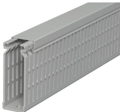
Verdrahtungskanal inkl. Oberteil und Bodenlochung, Verjüngungen in den Seitenschlitz verhindern das Herausfallen der Leitungen. Das Nennmaß der Systemgröße entspricht dem Innenmaß der Kanäle. Sonderlängen auf Anfrage.
