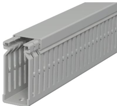
Verdrahtungskanal inkl. Oberteil und Bodenlochung, Verjüngungen in den Seitenschlitz verhindern das Herausfallen der Leitungen. Das Nennmaß der Systemgröße entspricht dem Innenmaß der Kanäle. Sonderlängen auf Anfrage.
