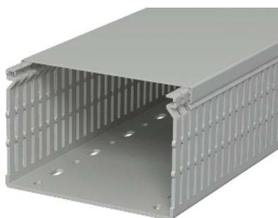
Verdrahtungskanal inkl. Oberteil und Bodenlochung, Verjüngungen in den Seitenschlitz verhindern das Herausfallen der Leitungen. Das Nennmaß der Systemgröße entspricht dem Innenmaß der Kanäle. Sonderlängen auf Anfrage.
