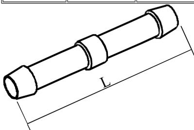
Złączka przeznaczona jest do łączenia przewodów izolowanych typu As x Sn .
