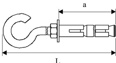
Śruba stosowana jest przy montażu zakotwień do naciągów na elewacjach budynków.
