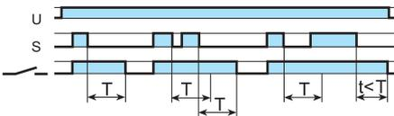
**(BE) Off-delay with control signal.**
