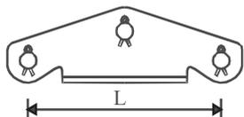
Przeznaczony do montażu łańcuchów izolatorowych.
