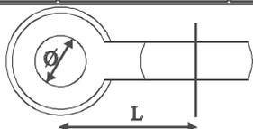
Przeznaczony do łączenia elementów łańcuchów izolatorowych.
