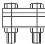
Służy do połączeń przewodów nie izolowanych AL. I AFL o przekroju j.w.
