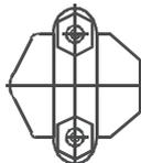
Przeznaczony jest do zamknięcia (zarabiania) pętli przewodów nie izolowanych o przekroju j.w.
