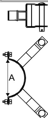
Stosowana do zawieszania przewodów gołych na słupach wirowych w ustawieniu rozgałęźnym odporowym i narożnym.
