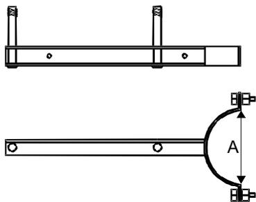
Konstrukcja przeznaczona do zawieszania przewodów AL gołych na słupach wirowych w układzie płaskim.
