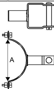
Konstrukcja przeznaczona do słupów wirowych w ustawieniu odporowym i narożnym. Układ sieci choinkowy lub naprzeciwległy.
