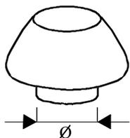
Stanowi zabezpieczenie stojaka dachowego przed wodą opadającą.
