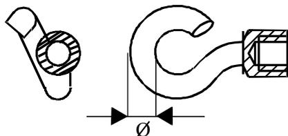
Wykorzystywany do zamocowania uchwyty odciągowej linii odgałęźnej przyłącza lub uchwyty przelotowego drugiego toru linii.
