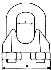
Zacisk przeznaczony jest do łączenia – zarabiania lin stalowych
