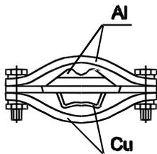
Zacisk przeznaczony jest do łączenia przewodów aluminiowych z przewodami miedzianymi
