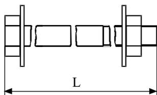
Śruba przeznaczona jest do montażu słupów typu: ŻN, BSW oraz wirowych.
