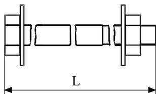
Śruba przeznaczona jest do montażu konstrukcji oraz uziemień linii NN i SN
