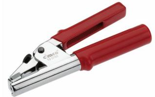
Abmantelzange Kaiman für Feuchtraumkabel bis 12mm Durchmesser, z. B. 7x1, 5 mm<sup>3</sup> oder 5x2, 5 mm<sup>3</sup>, Schnitttiefe einstellbar, besonders geeignet für Arbeiten an schwer zugänglichen Stellen (z. B. Schaltdosen)
